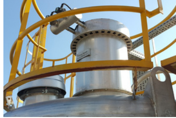
Silo Üstü Jet Filtreler
